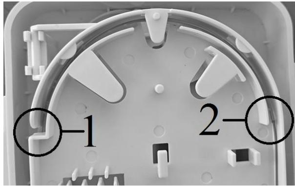
3.6 Заведіть модуль в сплайс-касету (1) і укладіть його до кінця тунелю(2). Відзначте модуль маркером в цьому місці та видаліть його, ретельно витерши волокна від гідрофоба..
